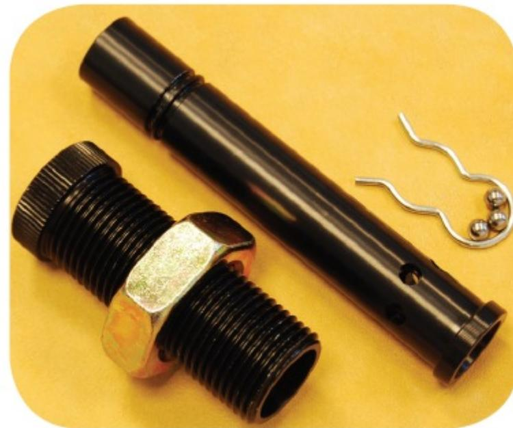
*La fotografia illustra la sezione inferiore del corpo del tubo di caduta smontata nei suoi componenti. Una volta rimossa la clip, il tubo interno si può sfilare verso il basso. Notate le tre sferette, che sono specifiche per ciascun calibro. Smontate l'assieme sopra un recipiente perché le sferette cadranno fuori quando estrarrete il tubo dal corpo filettato.*
