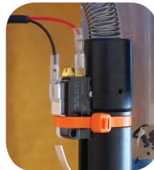
*Collegate i connettori del cavo retrattile ai connettori del microinterruttore, come illustrato. Il connettore centrale è piegato e non utilizzato. Non dovete preoccuparvi della polarità dei cavi.*
