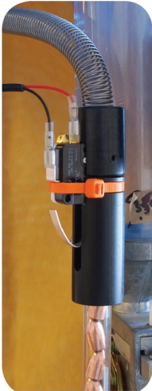
*Notate la posizione dell'innesto del tubo-molla agganciato alla parte superiore del tubo di caduta. Il suo lato piatto ingloba in parte il microinterruttore.*
