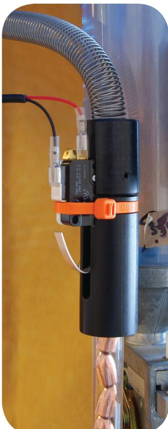
*Beachten Sie die Ausrichtung des Federadapters auf dem Geschossetzer. Der flache Teil stützt sich an der Schaltereinheit ab. Beachten Sie auch die beiden Drähte an den äußeren Klemmen des Schalters.*
