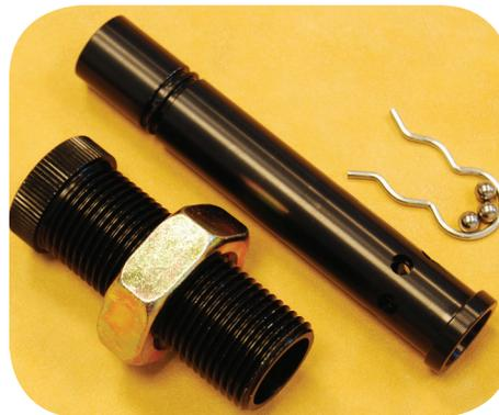
*Das Bild oben zeigt den zerlegten unteren Teil des Geschossetsers. Sobald die Sicherungsfeder entfernt wird, kann die innere Röhre herausgedrückt werden. Achten Sie hierbei auf die drei kleinen, kaliberspezifischen Kugellagerkugeln. Zerlegen Sie diesen Teil immer nur über einer Schüssel, da die Kugellagerkugeln herausfallen, sobald Sie die Röhre aus dem Gewindeteil herausdrücken.*
